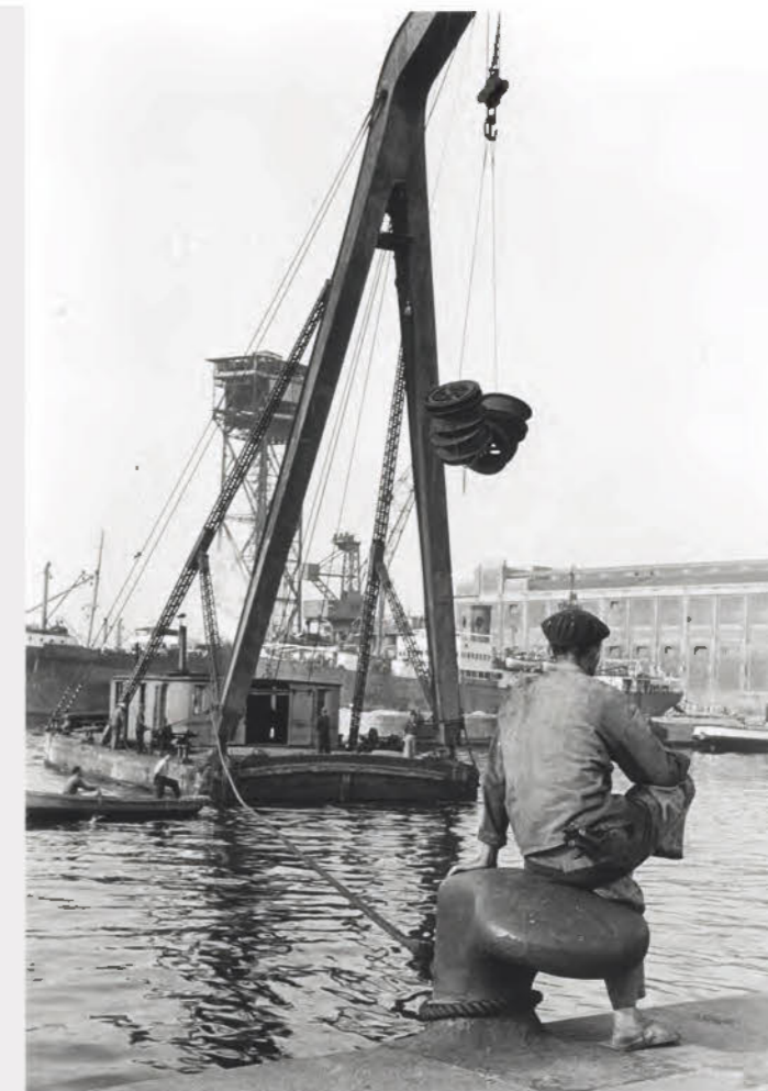
▲ Les càbries eren unes potents maquinàries utilitzades als ports per fer feixugues tasques de càrrega, ca. 1960. Foto: Xavier Agramont Cruanyes/MMB.
