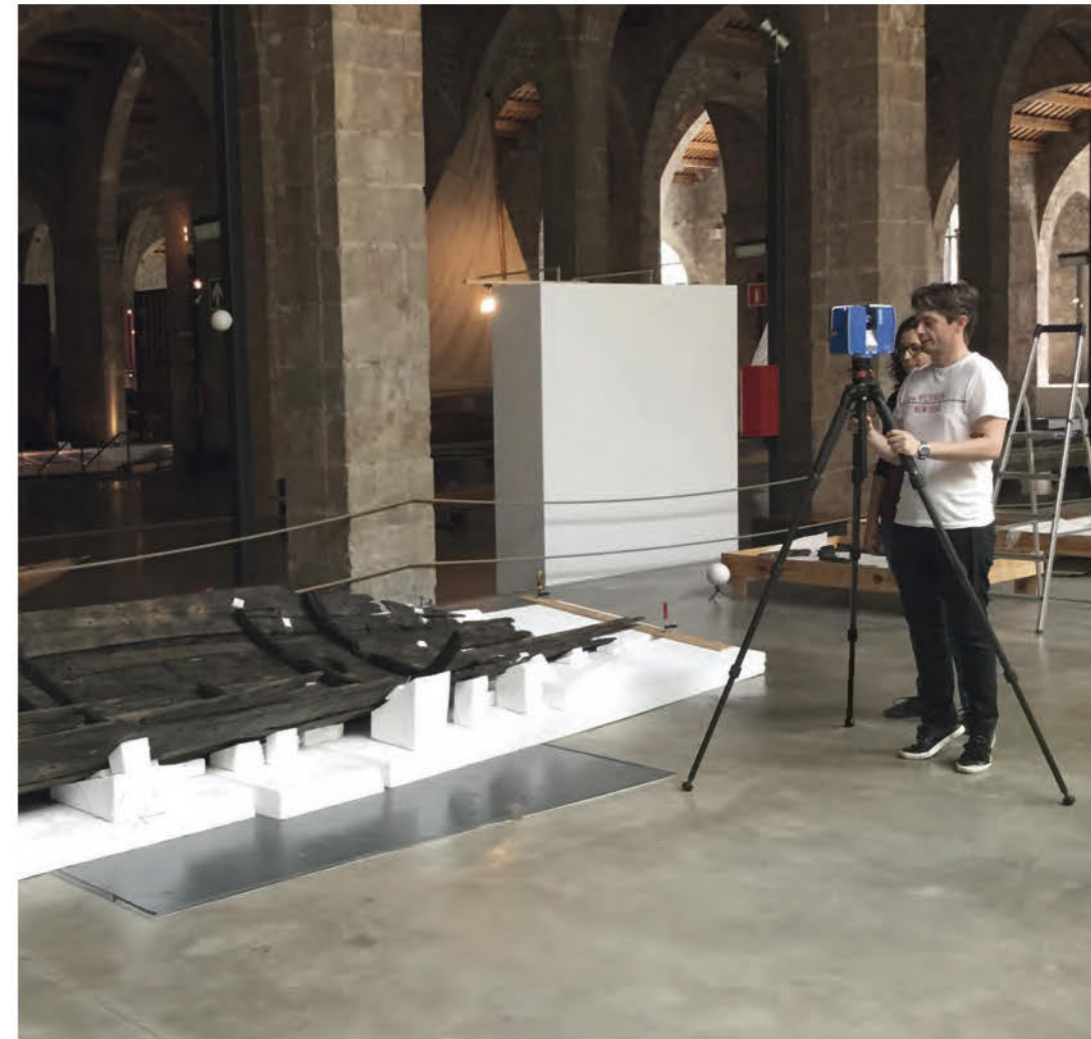
▲ Escaneig 3D del vaixell per fer el suport.
